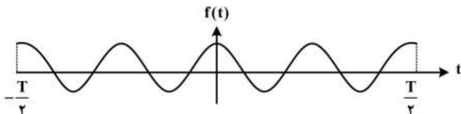
$$\frac{T}{4\pi} \left[ \sin\left(\frac{(\omega_0 - \omega)T}{2}\right) + \sin\left(\frac{(\omega_0 + \omega)T}{2}\right) \right] \quad (1)$$
