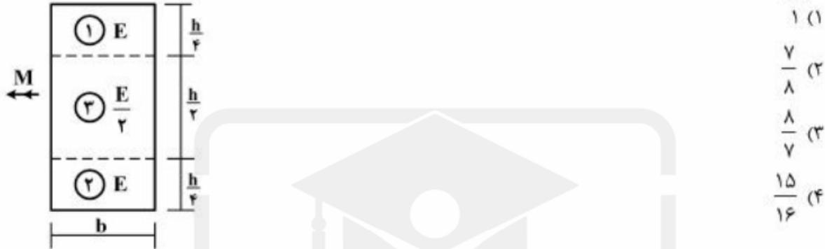
۲- در تیری با مقطع توخالی مطابق شکل، بر اثر نیروی برشی  $V$ ، بیشینه تنش برشی چه ضربی از  $\frac{V}{bh}$  می‌باشد؟
