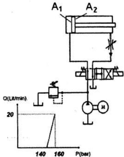
۱۳۰- در مدار زیر، قطر پیستون جک  $100 \text{ mm}$ ، قطر میله آن  $25 \text{ mm}$ ، کورس آن  $100 \text{ mm}$  و حجم جابه‌جایی
