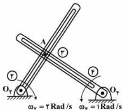
۱۰۵ - در مکانیزم روبرو، شتاب لغزندۀ A باشد تا شتاب لغزندۀ B صفر شود؟ سرعت لغزندۀ A برابر
