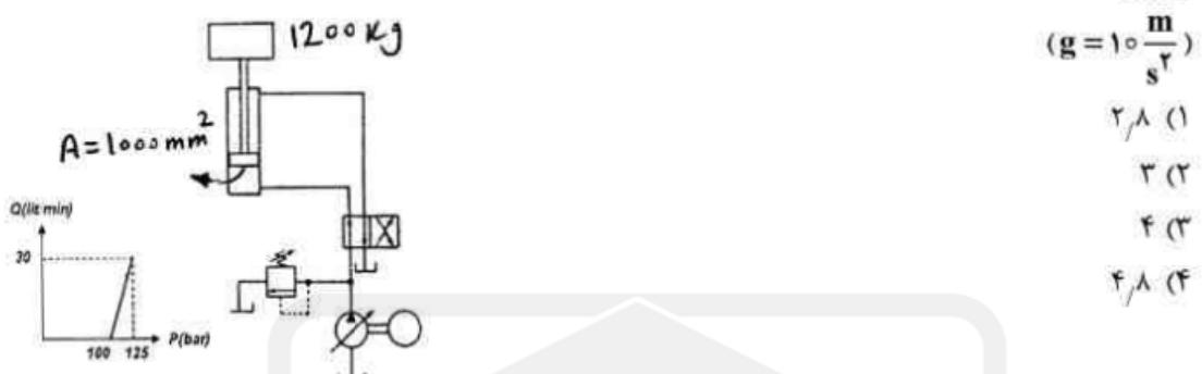
۱۲۸- در مدار زیر، در چه موقعی شیر فشار،  $40 \text{ Bar}$  را کنترل می‌کند؟
