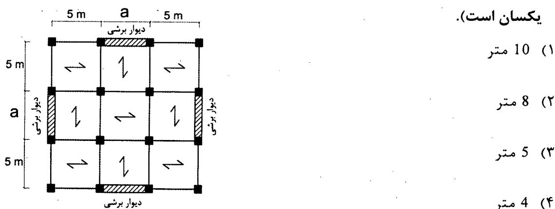
۱۳- در محاسبه برش پایه، برای ساختمان‌های منظم با سیستم قاب خمشی فولادی ویژه، به روش استاتیکی معادل در منطقه با خطر نسبی زیاد و زمین نوع یک، حداقل ارتفاع ساختمان از تراز پایه برای آنکه مقدار حاصل از رابطه برش پایه حداقل مورد استفاده قرار نگیرد (تعیین-کننده نباشد)، به کدامیک از مقادیر زیر نزدیک‌تر است؟ (فرض می‌شود که از رابطه تجربی برای محاسبه زمان تنابوب اصلی استفاده شده و جداول‌های میان‌قابلی مانعی برای حرکت جانبی قاب‌ها ایجاد نمی‌کنند).
