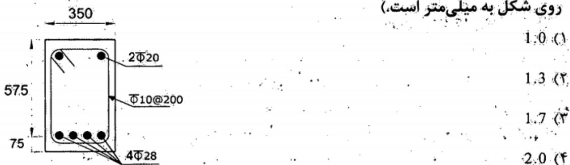
۳۵- در یک ساختمان پیشی در جا با شکل پذیری متوسط، در صورتی که نیروی محوری نهایی ستون های طبقه یا متر ۱۲ درصد حاصل ضرب مقاومت فشاری مشخصه بتن در سطح مقطع کلی ستون باشد، حداقل فاصله خاموت های بسته در طول ستون در نواحی بحرانی به کدامیک از مقادیر زیر نزدیک تر است؟ (فرض کنید برش نهایی عضو نیاز به آرماتور بیشتری را ایجاب نکند. بتن از ردہ C25 و فولاد از نوع S340 است. میلگرد های طولی Φ20، خاموت ها Φ10 و ابعاد ستون  $500 \times 500$  میلی متر و ارتفاع مؤثر مقطع ۴۲۰ میلی متر است).
