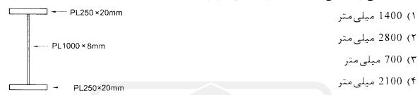
۱۰ چنانچه مقطع یک تیر مطابق شکل زیر باشد، طول مهارنشده آن که مرز بین حالت حدی تسلیم و حالت حدی کمانش پیچشی – جانبی غیرارتجاعی را مشخص میکند، به کدامیک از مقادیر زیر  $E = 2 \times 10^{5} \, \mathrm{MPa}$  .  $E = 200 \, \mathrm{MPa}$
