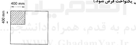
$000 \, \mathrm{kN.m}$  در یک اتصال دال به ستون، لنگر خمشی متعادل نشدهای ناشی از بارهای ثقلی برابر  $000 \, \mathrm{kN.m}$  باید بین دال و ستون میانی یک ساختمان منتقل شود. قسمتی از این لنگر که با عملکرد خمشی منتقل می شود (برحسب  $000 \, \mathrm{kN.m}$ ) به کدامیک از مقادیر زیر نزدیکتر است؟ فرض کنید ابعاد مقطع ستون  $000 \, \mathrm{kN.m}$  میباشد.
