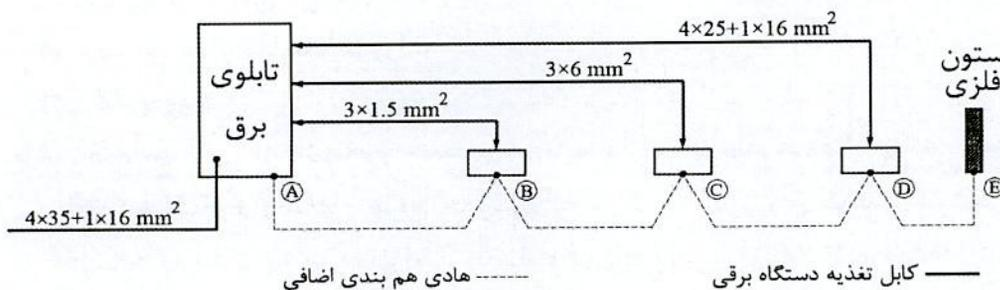
AB=2.5 mm<sup>2</sup>, BC=2.5 mm<sup>2</sup>, CD=6 mm<sup>2</sup>, DE=10 mm<sup>2</sup> (۱)
