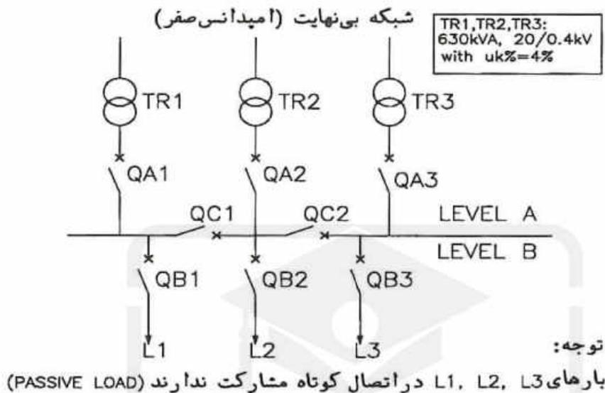
۲۲- جریان نامی  $I_n$  و تنظیم بهینه جریان قطع  $I_r$  (Overload Protection) کلیدهای اتوماتیک  $Q_A$  چه میزان است؟
