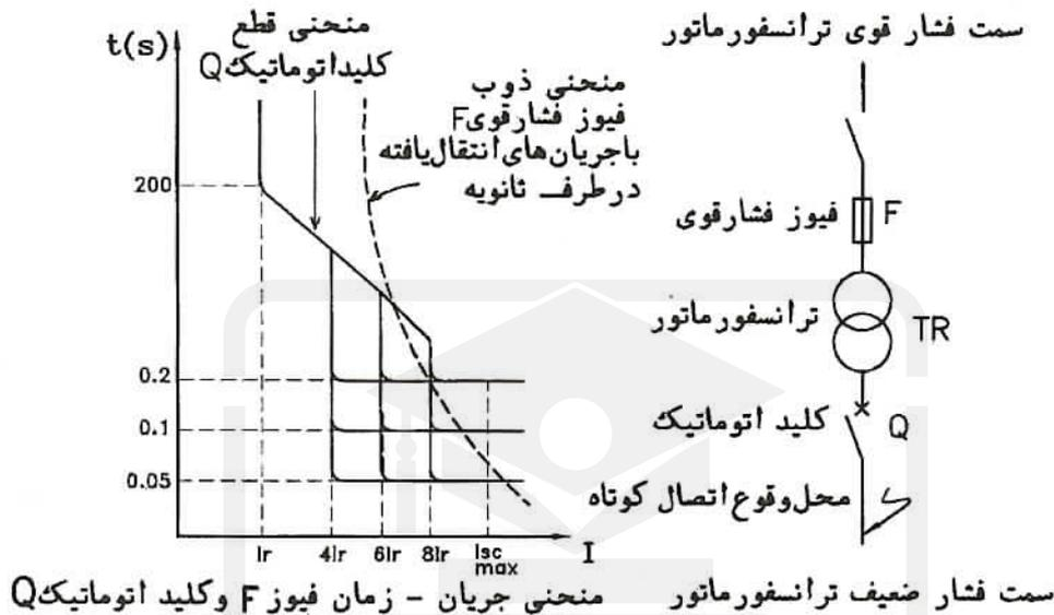
۳۰- تنظیم مغناطیسی کلید اتوماتیک Q حداکثر چه مقدار باشد تا بین فیوز F و این کلید سلکتیویته ایجاد گردد؟
