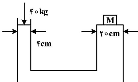
۴۲- در شکل روبه‌رو، وزن ماشین صنعتی چند کیلوگرم است؟
