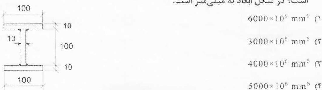
۴۴- فقط براساس کنترل برش در چشمهای ابتدایی و انتهایی، حد اکثر مقدار  $q_u$  قابل تحمل توسط تیر شکل زیر به کدامیک از گزینه‌ها نزدیک‌تر است؟ در شکل ابعاد به میلی‌متر است.
