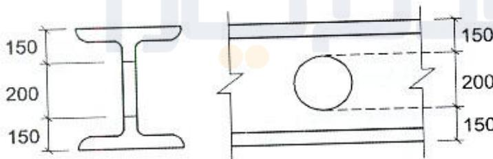
۴۹- فرض کنید مقاومت برشی اسمی یک مقطع I شکل ساخته شده از ورق با  $\frac{h}{t_w}=50$  برابر  $V_n$  است. اگر ضخامت جان این مقطع نصف شود، مقدار مقاومت برشی اسمی این مقطع حدوداً چقدر خواهد بود؟ فرض کنید مقاومت برشی اسمی در امتداد جان مقطع مدنظر است. همچنین فرض کنید عضو در طول خود فاقد سخت‌کننده‌های عرضی بوده و استفاده از آثار عمل‌میدان کششی مدنظر نیست.  $F_y=240$  MPa و  $E=2 \times 10^5$  MPa
